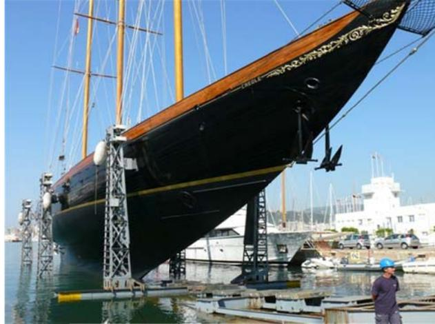
*Ilustración 5.- Elementos de izada y botadura actuales de los Astilleros de Mallorca*
