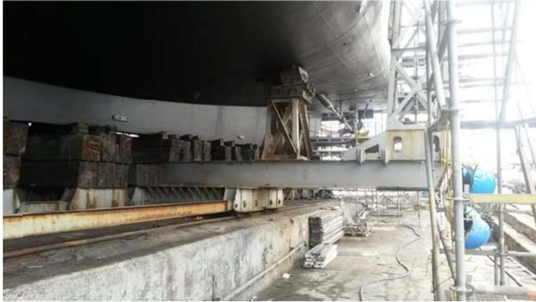
*Ilustración 10.- Detalle de las pantoqueras y carro con soporte de torres manual.*
