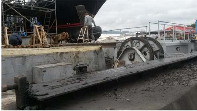
*Ilustración 4.- Imagen de un cabestrante actual de un varadero*
